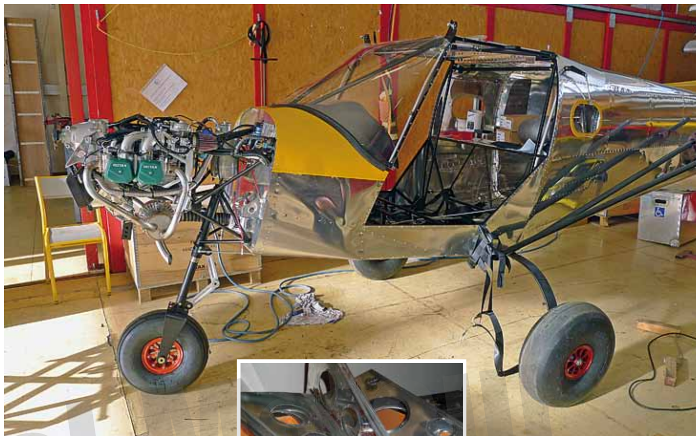
L'ensemble des éléments métalliques est découpé et embouti dans les locaux de Gap. L'assemblage est également réalisé ici, dans les Hautes-Alpes. Un ULM made in France !
