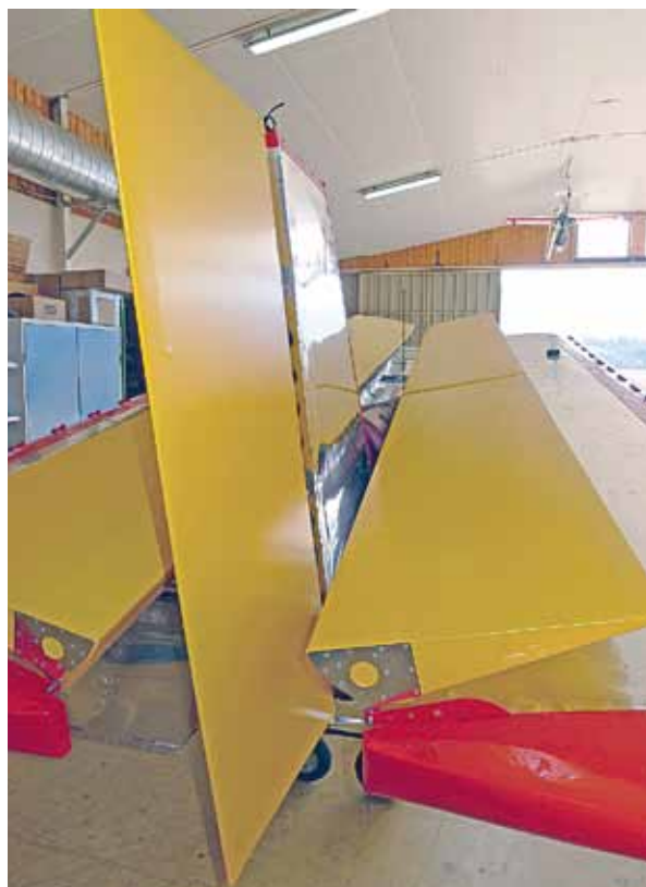
Le G1 est pliable... en série ! Un excellent point pour glisser son ULM dans les hangars bondés ou pour transporter sa machine sur une remorque. Sur la photo ci-dessus, on peut voir les volets et ailerons repliés sur le bord de fuite de l'aile. On notera au passage que ses gouvernes sont entoilées.
