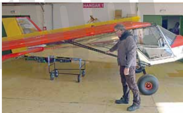
Le G1 est pliable... en série ! Un excellent point pour glisser son ULM dans les hangars bondés ou pour transporter sa machine sur une remorque. Sur la photo ci-dessus, on peut voir les volets et ailerons repliés sur le bord de fuite de l'aile. On notera au passage que ses gouvernes sont entoilées.
